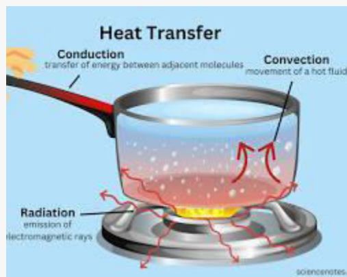
Конвекция на топлообмен
